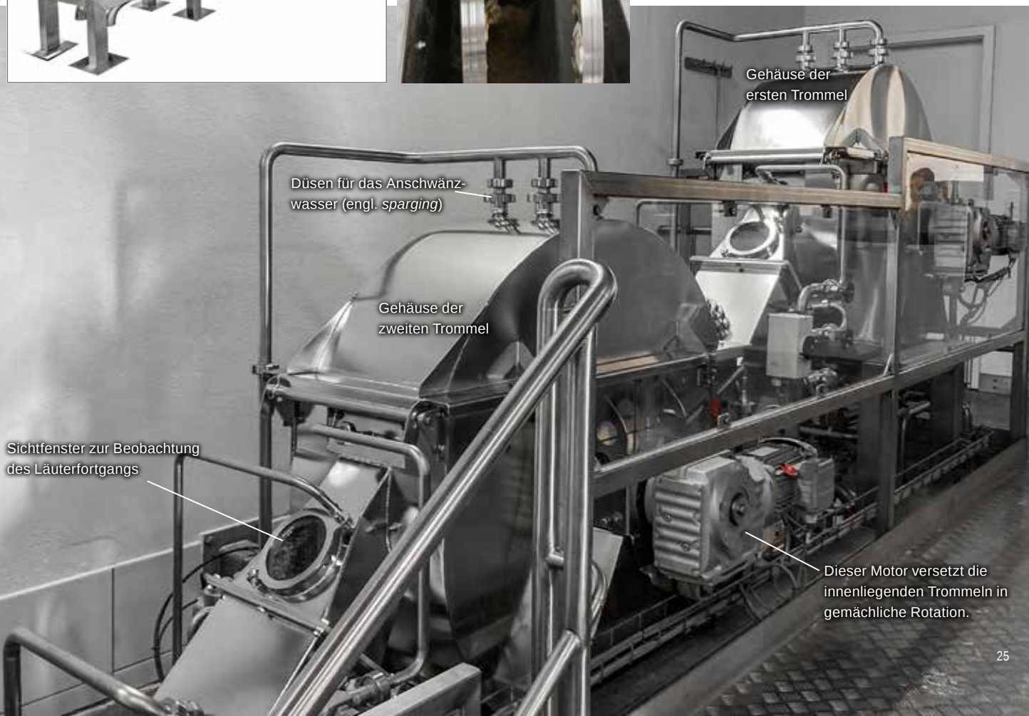
Das Nessie-System mit seinen ikonischen vier Höckern wurde passgenau in der Dresdner Whisky Manufaktur eingefügt. Ein Blick in sein Inneres zeigt die langsam rotierenden Trommeln mit den seitlichen Filtersieben. Die Schwerkraft lässt die Flüssigkeit aus dem Treber durch die feinen Poren der Siebe abfließen.
