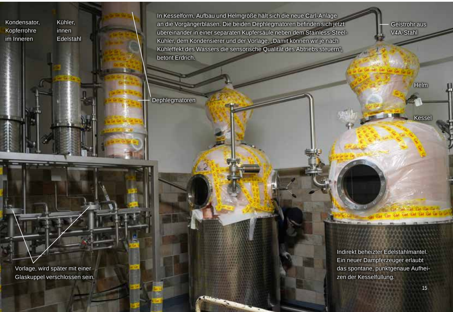
Bild unten: Die neue, dampfheizte Anlage, gefertigt nach Plänen von Gerald Erdrich und Alexander Plank, Carl GmbH, kurz nach dem Einbau im Januar 2024. „Der erste Brand wird ein Rothaus New Make“, freut sich Normann Oster. Zuvor werden sie, in Absprache mit dem Zoll, Testbrände mit Industrialkohol ausführen.
